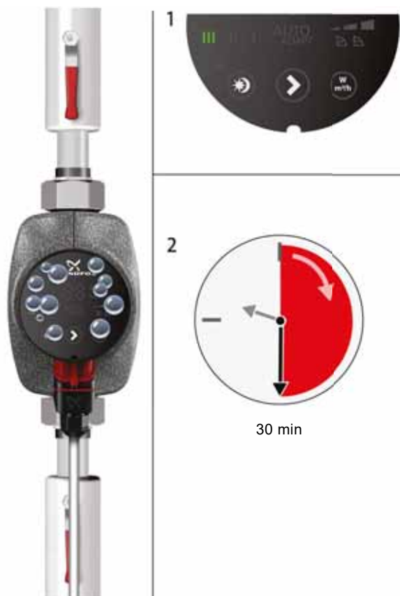
Fig. 8 Udluftning af pumpen
